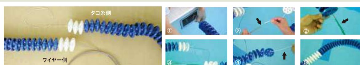
各梱包を開けると、50mのワイヤーに25m分のフロートが通っているものとタコ糸に25m分のフロートが通っているものと分かれます。
