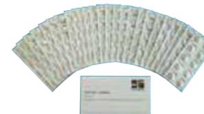
速溶性錠剤タイプの試薬で、緩衝液が不要ですから作業が簡単です。東京都の水道局でも採用されています。
