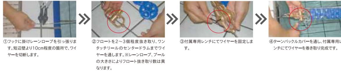
①フックに掛けレーンロープを引っ張り、短辺壁より10cm程度の箇所で、ワイヤーを切断します。
