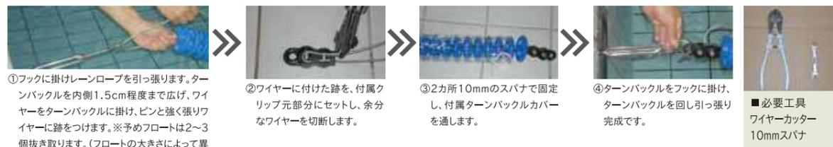
①フックに掛けレーンロープを引っ張り、ターンバックルを内側1.5cm程度まで広げ、ワイヤーをターンバックルに掛け、ピンと強く張りワイヤーに跡をつけます。※予めフロートは2〜3個抜き取ります。(フロートの大きさによって異なります)
